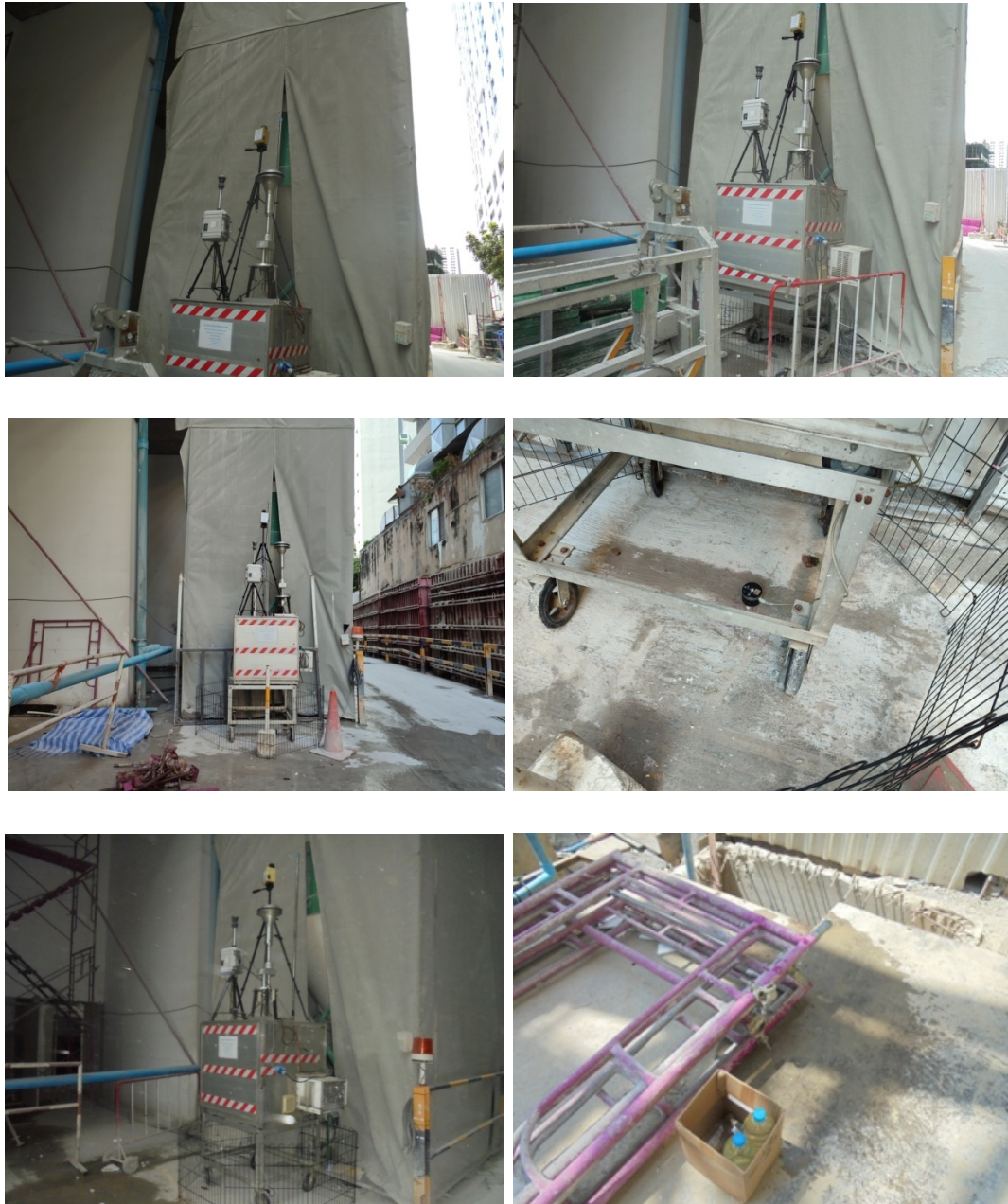
จุดตรวจวัดคุณภาพอากาศ เสียง และแรงสั่นสะเทือน จุดตรวจวัดก๊าซมลพิษ CO SO 2 NO 2 และ HC และเก็บตัวอย่างน้ำทิ้ง
