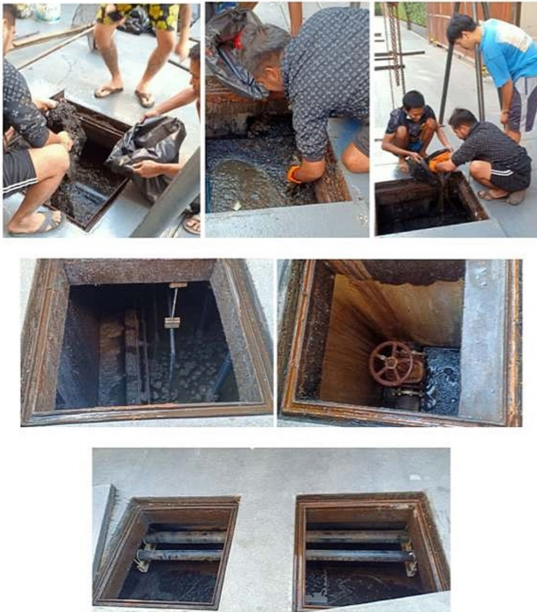
ภาพที่ 3-37 สุ่มตะกอนในระบบบำบัดน้ำเสีย
