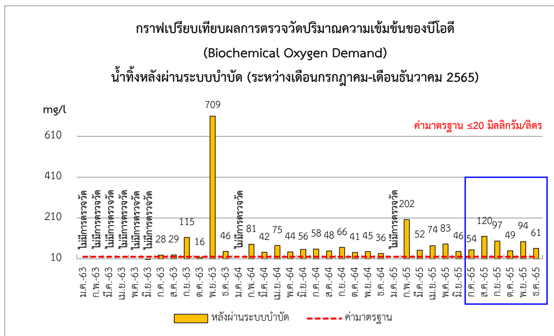
รูปที่ 4.4.1-2 กราฟเปรียบเทียบผลการตรวจวัดความเข้มข้นของบีโอดี (Biochemical Oxygen Demand) ของน้ำทิ้งหลังการบำบัด (ตรวจวัดในเดือนกรกฎาคม 2565 – เดือนธันวาคม 2565)
