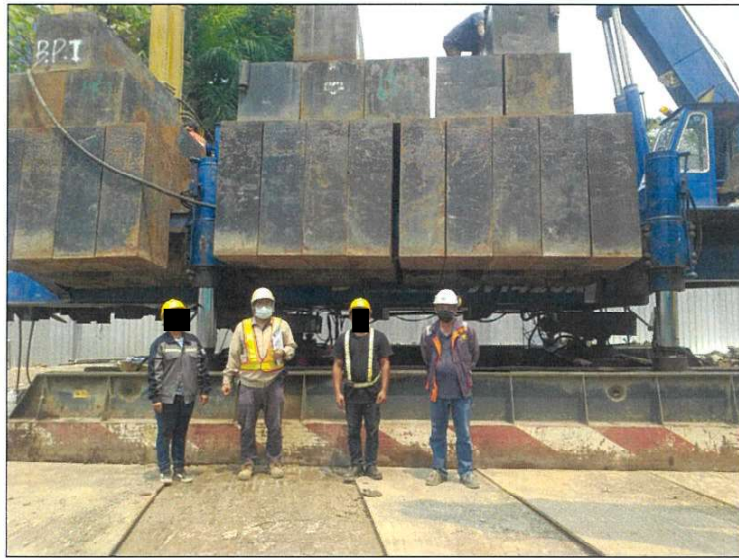
ตรวจ ปจ.2 รถกตเส้าเข็ม JYV 420A Crane 16 ตัน Boom 14.50 เมตร ปจ.นายอานนท์ มะโหฬาร หน่วยงาน เทอร์ติไนน์ สวีทส์ - 39 Luxury Suites สุขุมวิท 39 (ตรวจวันที่ 7 เมษายน 65)
