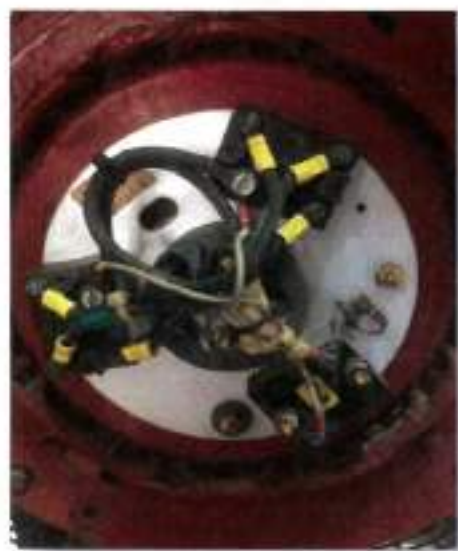
5.) ทำการวัดค่าความต้านทานของขดลวด
