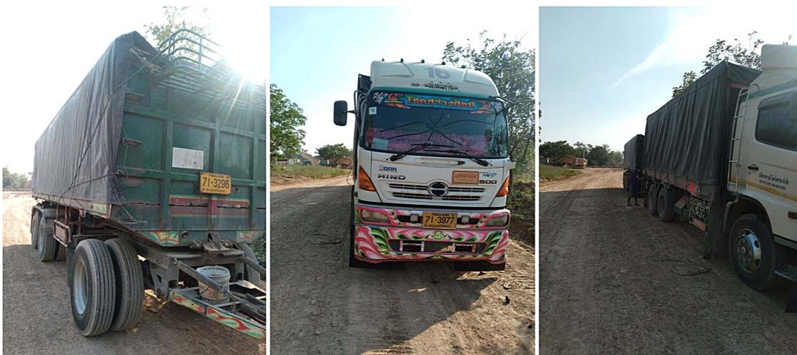
ภาพที่ 5-10 ปิดคลุมกระบะบรรทุกด้วยผ้าใบป้องกันการร่วงหล่นของวัสดุ
