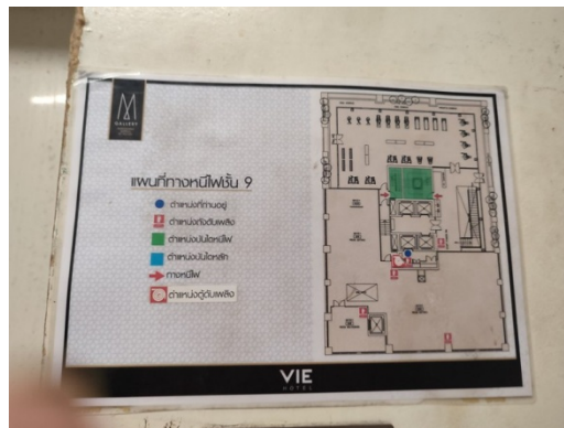
ภาพที่ 4-15 ป้ายแผนผังแสดงตำแหน่งของอุปกรณ์ดับเพลิงและเส้นทางหนีไฟ
