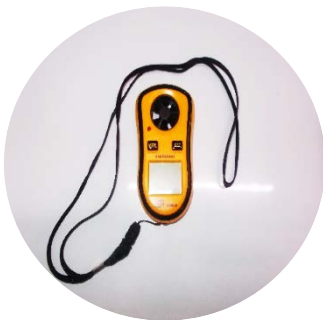
เครื่องวัดความเร็วลม ใช้วัดความเร็วลมของพัดลม อัดอากาศภายในบันไดหนีไฟ
