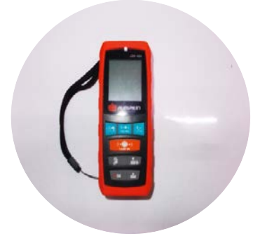
เครื่องวัดระยะทางแบบดิจิทัล ใช้ตรวจวัดระยะการติดตั้งอุปกรณ์แจ้งเหตุเพลิงไหม้อัตโนมัติ
