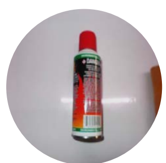
ควันเทียม ใช้ทดสอบอุปกรณ์แจ้งเหตุ เพลิงไหม้อัตโนมัติ
