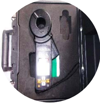
เครื่องวัดความต้านทานดินแบบดิจิทัล ใช้วัดความต้านทานดินของระบบป้องกันฟ้าผ่า
