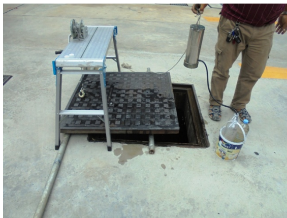
เก็บตัวอย่างน้ำทิ้งที่บ่อพักน้ำโสหลังจากออกจากระบบบำบัดน้ำเสีย ด้วยวิธี Sampling Pump
