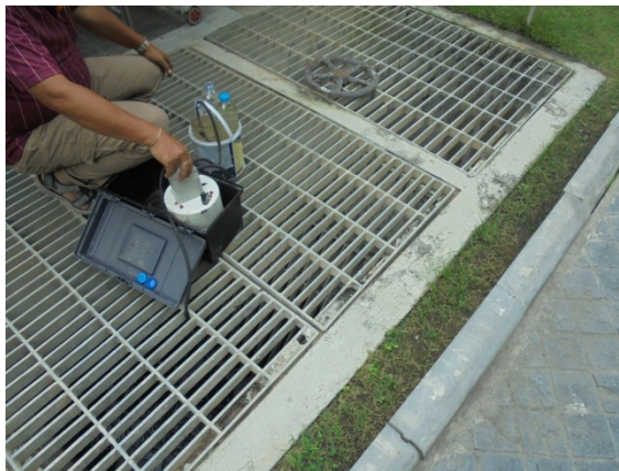
เก็บตัวอย่างน้ำทิ้งที่บ่อตรวจคุณภาพน้ำทิ้ง ด้วยวิธี Sampling Pump
