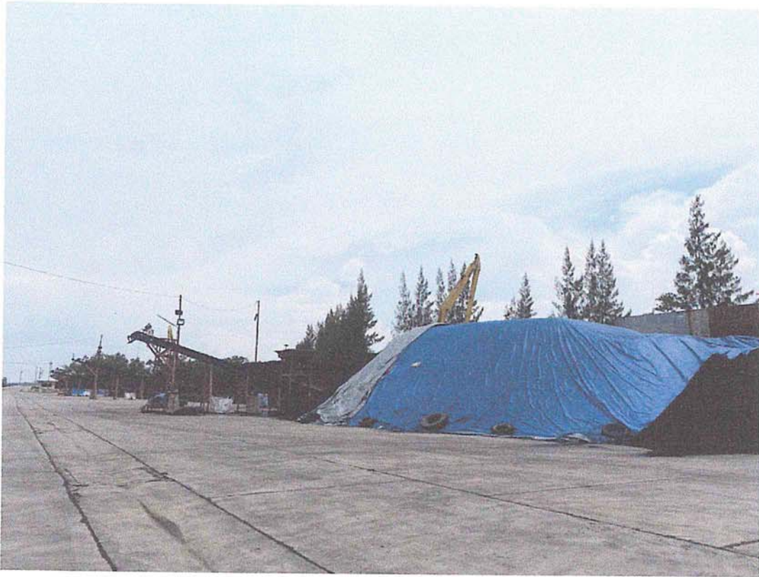
ภาพที่ 1 มีการใช้ผ้าใบปกคลุมกองกะลาปาล์มในส่วนที่ยังไม่ได้ใช้งานเพื่อทำให้เกิดความชื้นและป้องกันปัญหาการเกิดฝุ่นละออง
