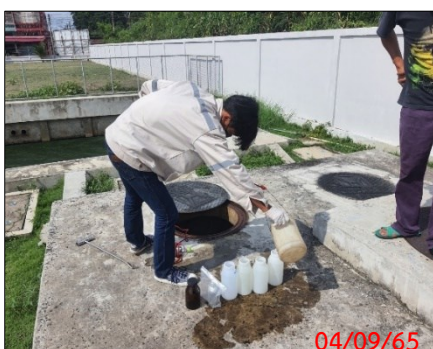
บริเวณถังพักน้ำทิ้งหลังออกจากระบบบำบัดน้ำเสียรวม รูปที่ 3.2-3 การเก็บน้ำประจำเดือนกันยายน
