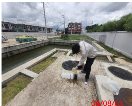
บริเวณถังพักน้ำทิ้งหลังออกจากระบบบำบัดน้ำเสียรวม รูปที่ 3.2-2 การเก็บน้ำประจำเดือนสิงหาคม
