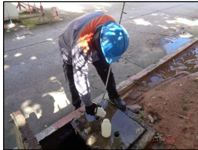
บ่อพักน้ำทิ้งสุดท้ายก่อนระบายออกจากพื้นที่โครงการ รูปที่ 3-5 แสดงการเก็บตัวอย่างน้ำทิ้ง เดือนตุลาคม 2565
