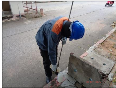
บ่อพักน้ำทิ้งสุดท้ายก่อนระบายออกจากพื้นที่โครงการ รูปที่ 3-4 แสดงการเก็บตัวอย่างน้ำทิ้ง เดือนกันยายน 2565
