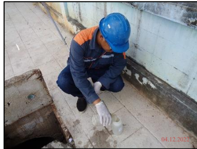
บ่อพักน้ำทิ้งสุดท้ายก่อนระบายออกจากพื้นที่โครงการ รูปที่ 3-2 แสดงการเก็บตัวอย่างน้ำทิ้ง เดือนธันวาคม 2565
