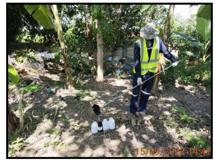
บ่อดตรวจวัดคุณภาพน้ำก่อนระบายออก จากโครงการ ส่วนที่ 1
