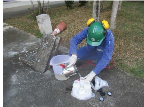
บ่อตรวจสอบน้ำทิ้งก่อนออกบริเวณจุดเชื่อมต่อน้ำเสีย ของโครงการกับท่อสาธารณะสุขของเทศบาลบางเสร่
