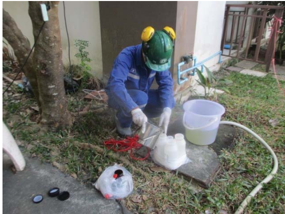
บ่อตรวจสอบน้ำเสียก่อนเข้าระบบบำบัดน้ำเสีย
