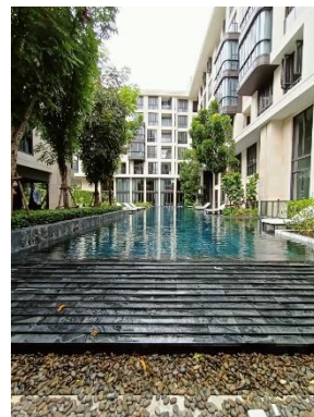
รูปที่ 2-50 พื้นทางเดินรอบสระให้มีลักษณะเป็นผิวหยาบ หรือเป็นพื้นหินล้างเพื่อป้องกันการลื่นล้ม
