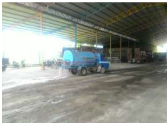
รูปที่ 7 ฉีดพรมน้ำบริเวณเส้นทางการขนส่งแร่
