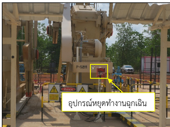
ภาพที่ 2.4-7 อุปกรณ์หยุดการทำงานฉุกเฉิน (OSD)
