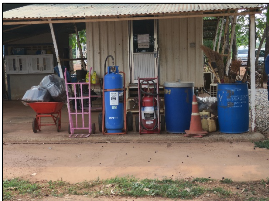
ภาพที่ 2.4-26 เครื่องมือ/อุปกรณ์ดับเพลิงและจัดคราบน้ำมันประจำวันหลุมผลิต
