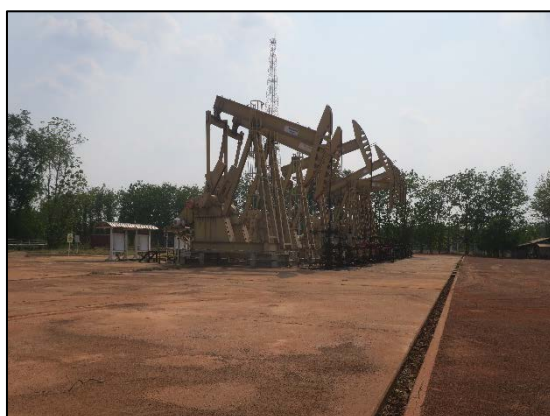
ภาพที่ 2.4-9 การจัดวางและติดตั้งอุปกรณ์การผลิตบนพื้นคอนกรีตที่มีรางระบายน้ำล้อมรอบ
