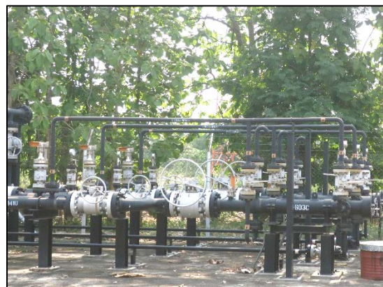
ภาพที่ 2.4-5 ระบบวาล์วบริเวณหัวบ่อ Christmas Tree และ Choke manifold
