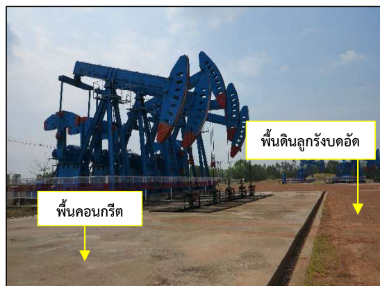
ภาพที่ 2.2-7 การวางอุปกรณ์การผลิตบนพื้นคอนกรีต
