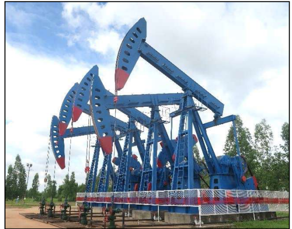
2) เครื่องสูบแบบโยก (Beam Pump)
