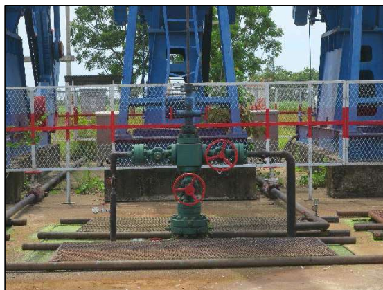
ภาพที่ 2.1-9 ชุดวาล์วปากหลุม (Well Head Unit)
