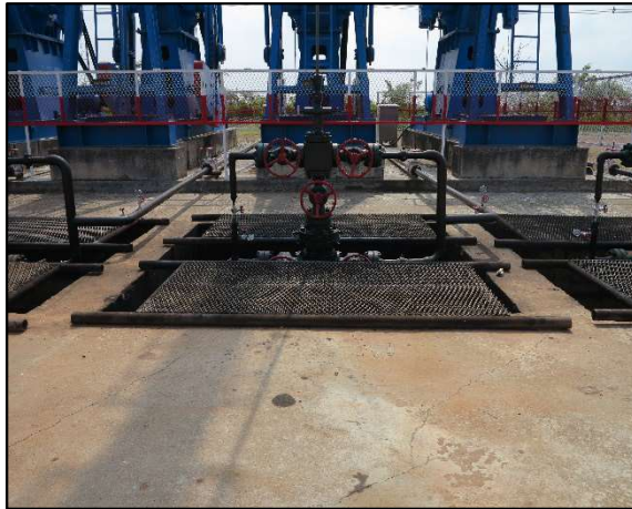
1) ชุดวาล์วปากหลุม (Well Head Unit)
