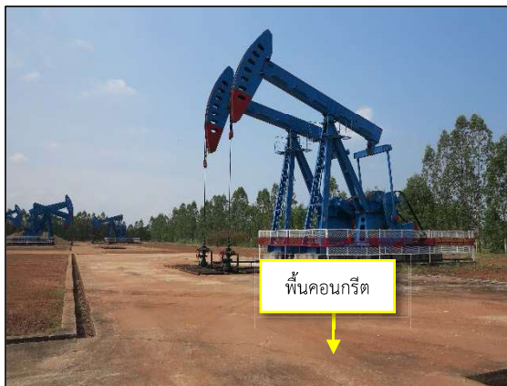
ภาพที่ 2.1-2 พื้นคอนกรีตและรางระบายน้ำล้อมรอบอุปกรณ์การผลิตปิโตรเลียม
