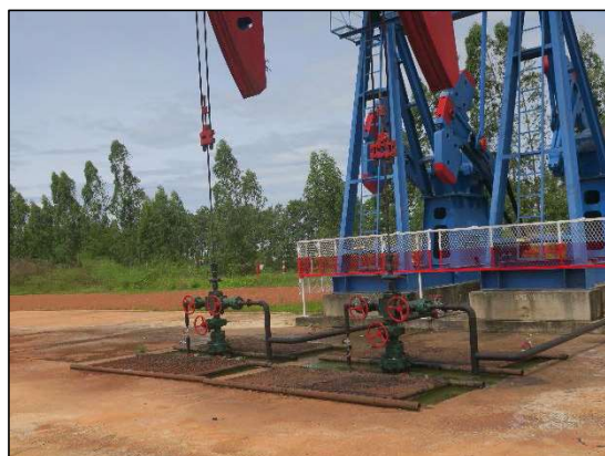
ภาพที่ 2.2-7 การวางอุปกรณ์การผลิตบนพื้นคอนกรีต
