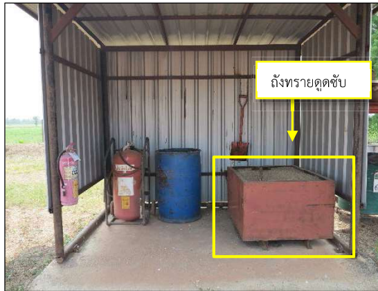
ภาพที่ 2.2-1 อุปกรณ์ดูดซับและทำความสะอาดคราบน้ำมัน
