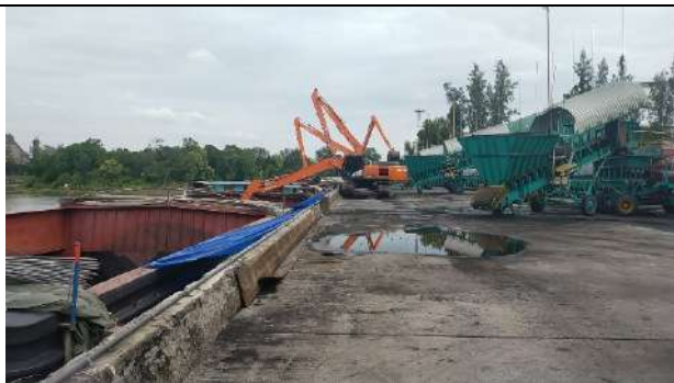
รูปที่ 2.2-11 การชิงผ้าพลาสติกระหว่างทำกับเรือตลอดแนวระวางสินค้าที่มีการขนถ่ายถ่านหิน
