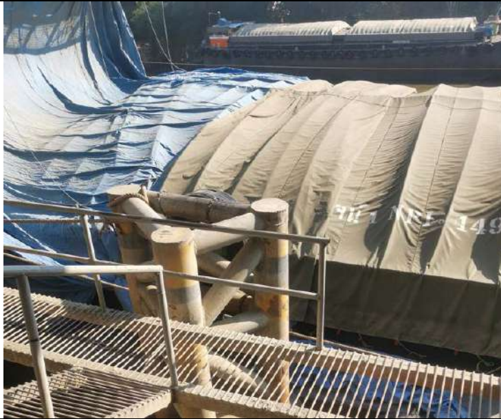
รูปที่ 2.2-22 ผ้าใบคลุมโกรกลงสินค้าขณะขนถ่ายปูนเม็ดลงเรือลำเลียง
