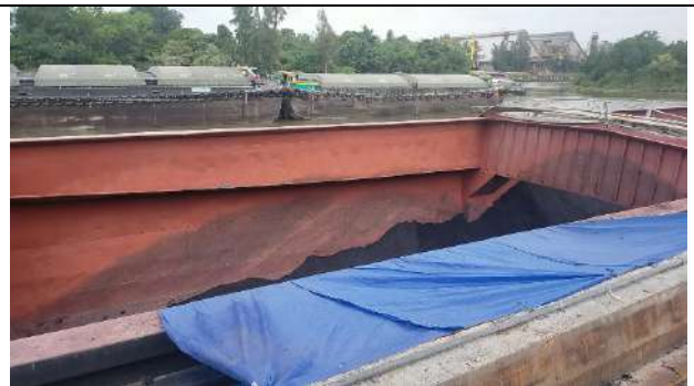
รูปที่ 2.2-11 การชิงผ้าพลาสติกระหว่างทำกับเรือตลอดแนวระวางสินค้าที่มีการขนถ่ายถ่านหิน
