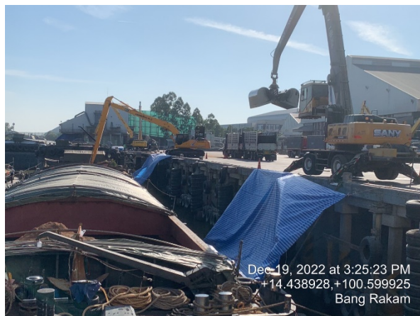
รูปที่ 2.2-17 การชิงผ้าใบหรือผ้าพลาสติกระหว่างเรือลำเลียงสินค้าและท่าเทียบเรือ
