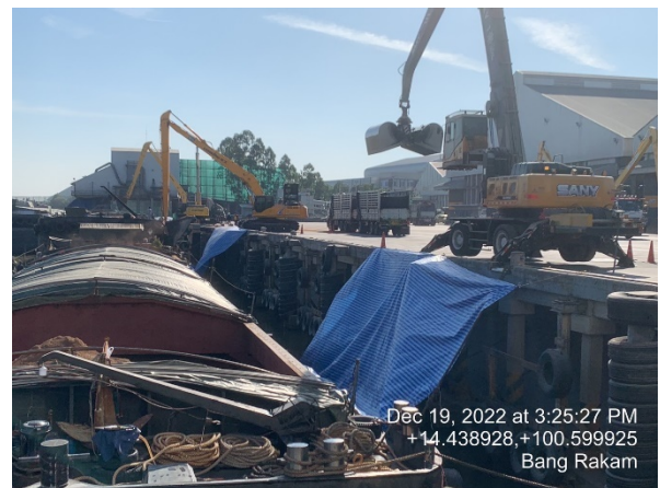
รูปที่ 2.2-17 การชิงผ้าใบหรือผ้าพลาสติกระหว่างเรือลำเลียงสินค้าและท่าเทียบเรือ
