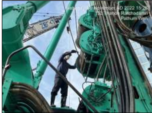
ภาพที่ 2- 60 ตรวจสอบระบบเบรก Limit Switch
