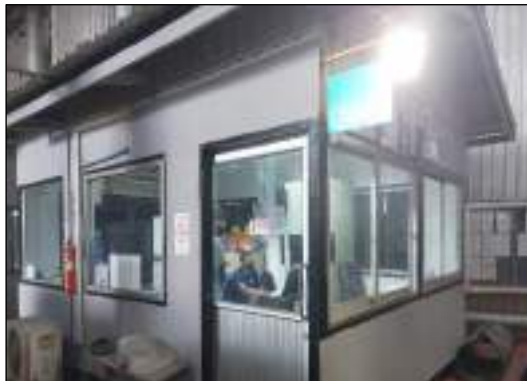
รูปที่ 68 ห้องควบคุมกันเสียงระหว่างเครื่องจักรกับผู้ปฏิบัติงาน
