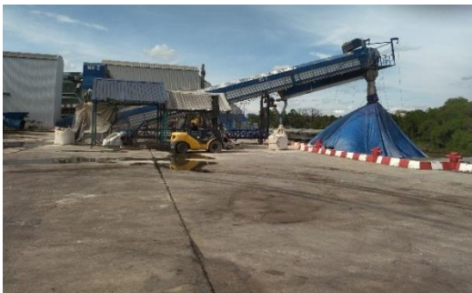
การขนถ่ายมันเส้นผ่าน โกรกลงสินค้า B สายพานลำเลียงมันเส้น บริเวณท่าเทียบเรือที่ 2
