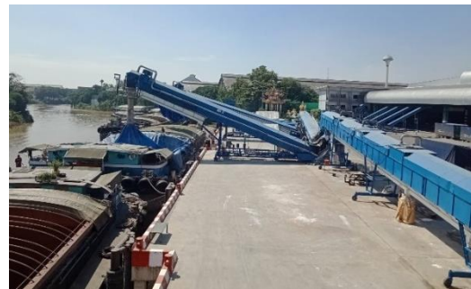
การขนถ่ายมันเส้นผ่าน โกรกลงสินค้า B สายพานลำเลียงมันเส้น บริเวณท่าเทียบเรือที่ 2
