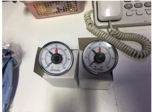
ทำการเปลี่ยน pressure gauge ถังกรองสรวายน้ำตามทีม PM ส่วนกลางแจ้ง
