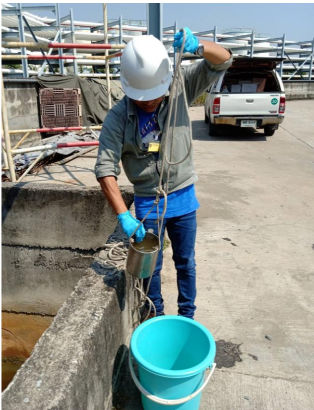
ภาพที่ 3-8 อุปกรณ์และวิธีการเก็บตัวอย่างน้ำทิ้ง
