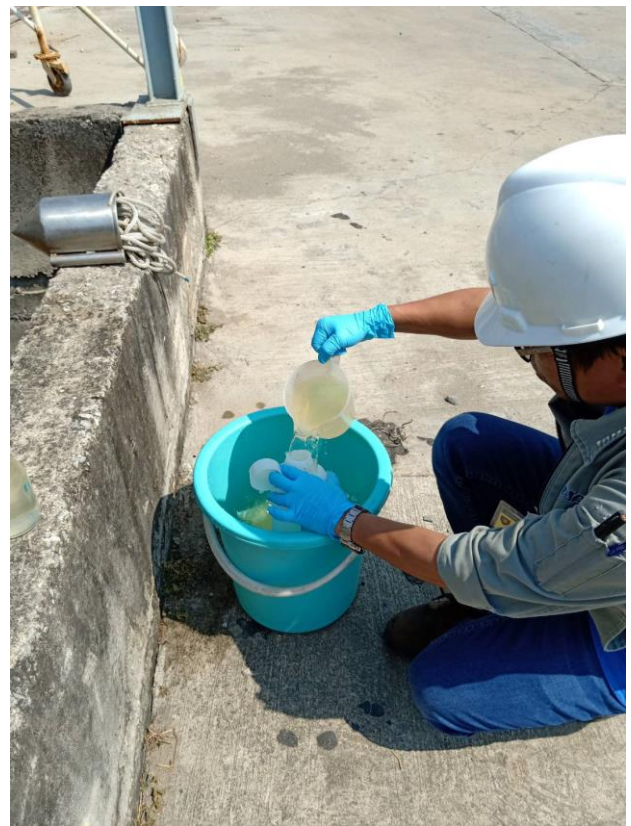
ภาพที่ 3-8 อุปกรณ์และวิธีการเก็บตัวอย่างน้ำทิ้ง
