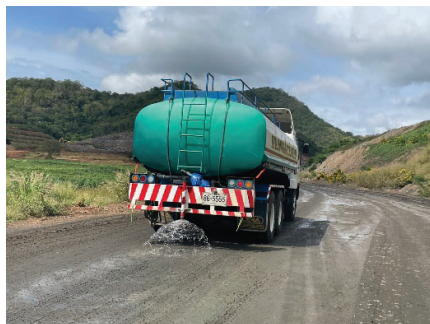
รูปที่ 2-29: การฉีดพรมน้ำบนเส้นทางขนส่งแร่
