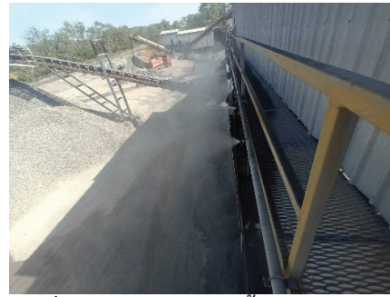
รูปที่ 2-34: ระบบสเปรย์น้ำของโรงโม่หิน
