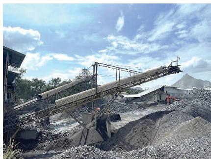
รูปที่ 2-31: การปิดคลุมสายพานลำเลียงแร่
