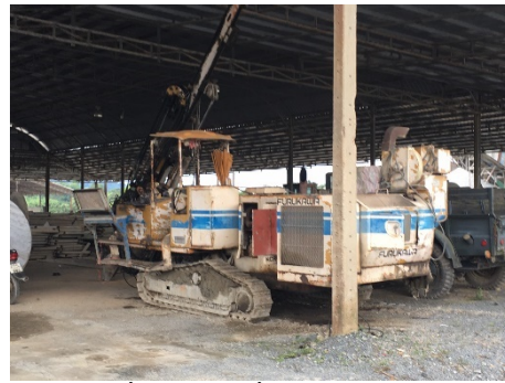
รูปที่ 2-23: เครื่องเจาะระเบิด
