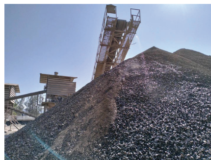
รูปที่ 2-22: ระบบฉีดสเปรย์น้ำในโรงโม่หิน
