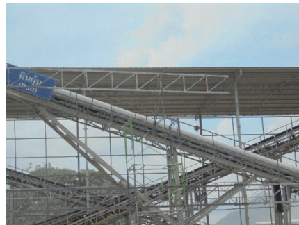
รูปที่ 2-20: การปิดคลุมสายพานในโรงโม่หิน
