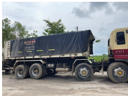
รูปที่ 2-7: การปิดคลุมผ้าใบรถบรรทุกทุกแร่
