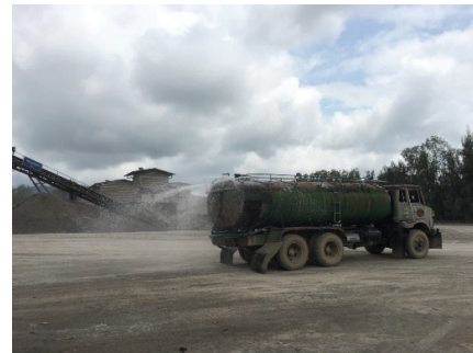
รูปที่ 2-10: การฉีดพรมน้ำบริเวณโรงโม่หินของโครงการ
