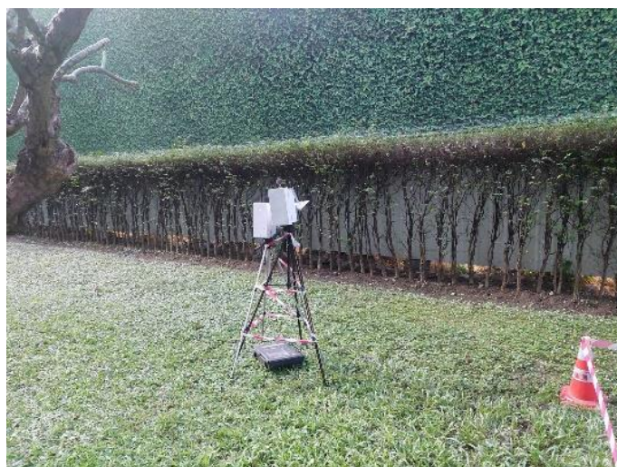
รูปที่ 3.50 การตรวจวัดความสั่นสะเทือนภายในพื้นที่อาคารชุดพักอาศัยเดอะเม็ท
