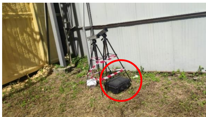
รูปที่ 3.49 การตรวจวัดความสั่นสะเทือนภายในพื้นที่โครงการทางด้านทิศตะวันตกซึ่งติดกับสถานเอกอัครราชทูตสิงคโปร์
