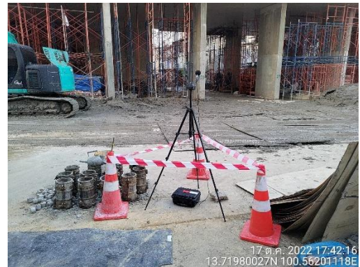
รูปที่ 24 ติดตั้งเครื่องมือตรวจวัดคุณภาพสิ่งแวดล้อม (คุณภาพอากาศ ระดับเสียง ความสั่นสะเทือน)
