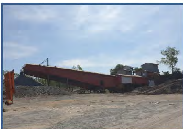
รูปที่ 2-10 การปิดปกคลุมสายพานลำเลียง
