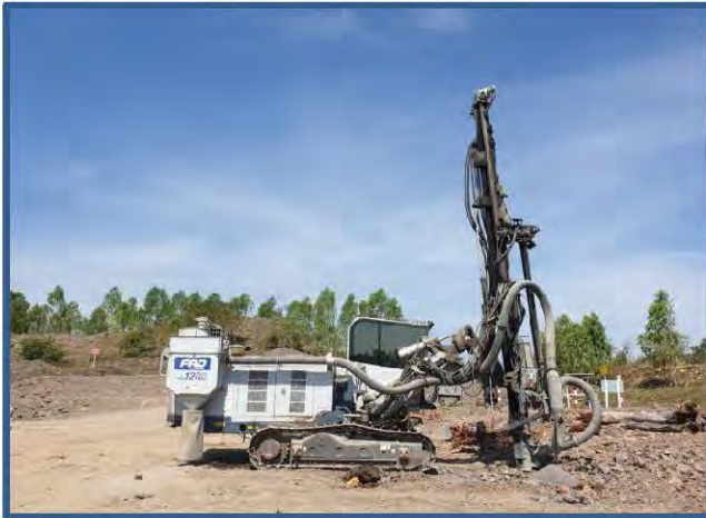
รูปที่ 2-25 เครื่องเจาะระเบิดที่มีอุปกรณ์เก็บฝุ่น
