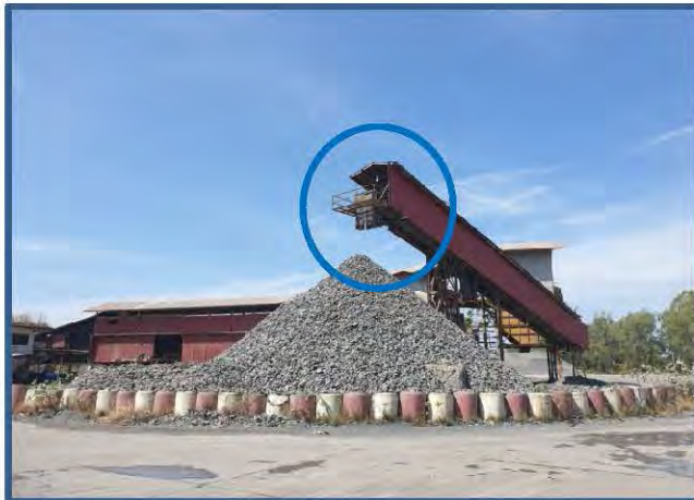
รูปที่ 2-11 การปิดปกคลุมปลายสายพานลำเลียง
