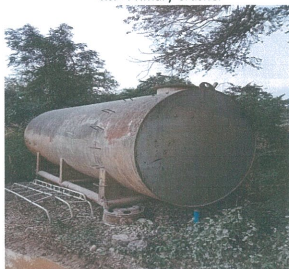
รูปที่ 12 ถังเก็บน้ำสำหรับประพรมในโรงโม่หิน
