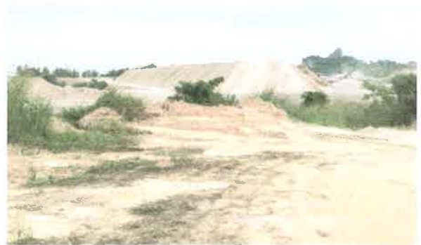
รูปที่ 4 เปลือกดินจากหน้าเหมืองนำมาผสมเป็นหินคลุก
