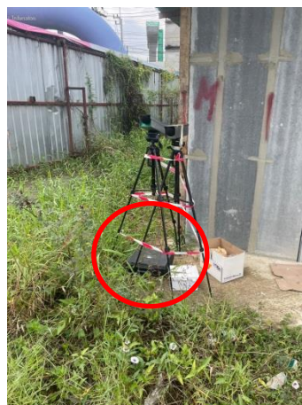
รูปที่ 3.24 การตรวจวัดความสั่นสะเทือน บริเวณพื้นที่โครงการ
