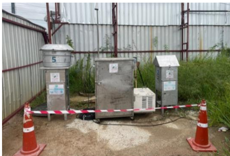
รูปที่ 3.2 การเก็บตัวอย่างคุณภาพอากาศในบรรยากาศ บริเวณพื้นที่โครงการ
