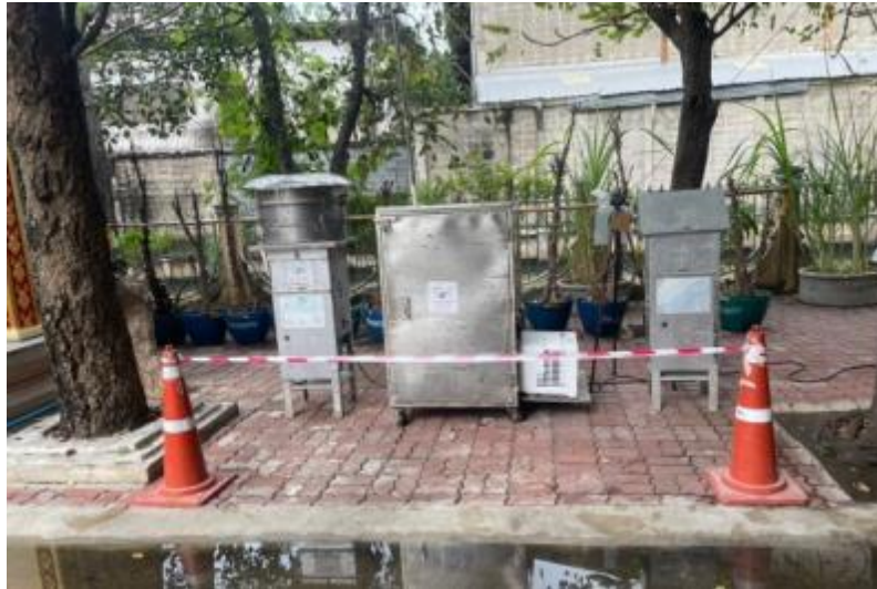
รูปที่ 3.3 การเก็บตัวอย่างคุณภาพอากาศในบรรยากาศ บริเวณวัดยายร่ม
