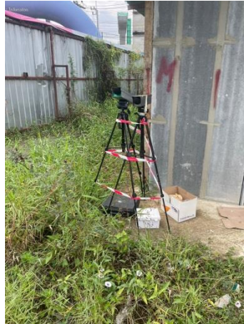
รูปที่ 3.17 การตรวจวัดระดับเสียงโดยทั่วไป และระดับเสียงรบกวน บริเวณพื้นที่โครงการ
