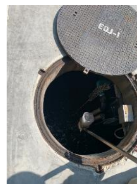
รูปที่ 3.30 ภาพแสดงการเก็บตัวอย่างน้ำจุดที่ 2 คุณภาพน้ำทิ้งหลังการบำบัด บ่อพักน้ำใส ระบบบำบัดน้ำเสียอาคาร A
