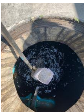
รูปที่ 3.29 ภาพแสดงการเก็บตัวอย่างน้ำจุดที่ 1 คุณภาพน้ำก่อนการบำบัด บ่อปรับสภาพสมดุล ระบบบำบัดน้ำเสียอาคาร A
