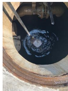
รูปที่ 3.32 ภาพแสดงการเก็บตัวอย่างน้ำจุดที่ 4 คุณภาพน้ำทิ้งหลังการบำบัด บ่อพักน้ำใส ระบบบำบัดน้ำเสียอาคาร B
