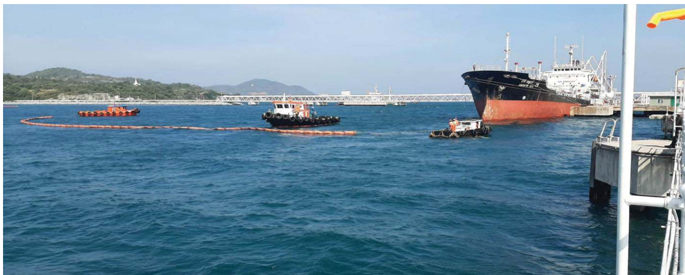
STT 13 เรือทัก ACS 2 นำทีมขจัดคราบเข้าทำการเก็บคราบน้ำมัน ใน BOOM
