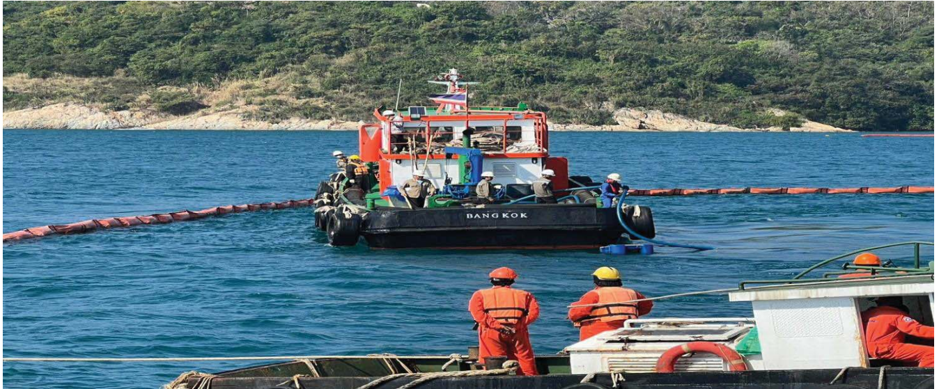
STT 15 เรือทัก ACS 2 นำ DISSKIMMER ทำการเก็บคราบน้ำมัน ใน BOOM
