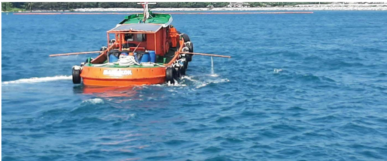
STT 18 เรือทัก ACS 1 ฉีดน้ำยา DISPERSANT ฉีดคราบน้ำมันภายนอก BOOM
