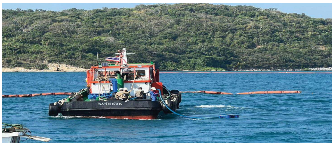
STT 14 เรือทัก ACS 2 นำ DISSKIMMER ลงน้ำเพื่อทำการเก็บคราบน้ำมัน ใน BOOM
