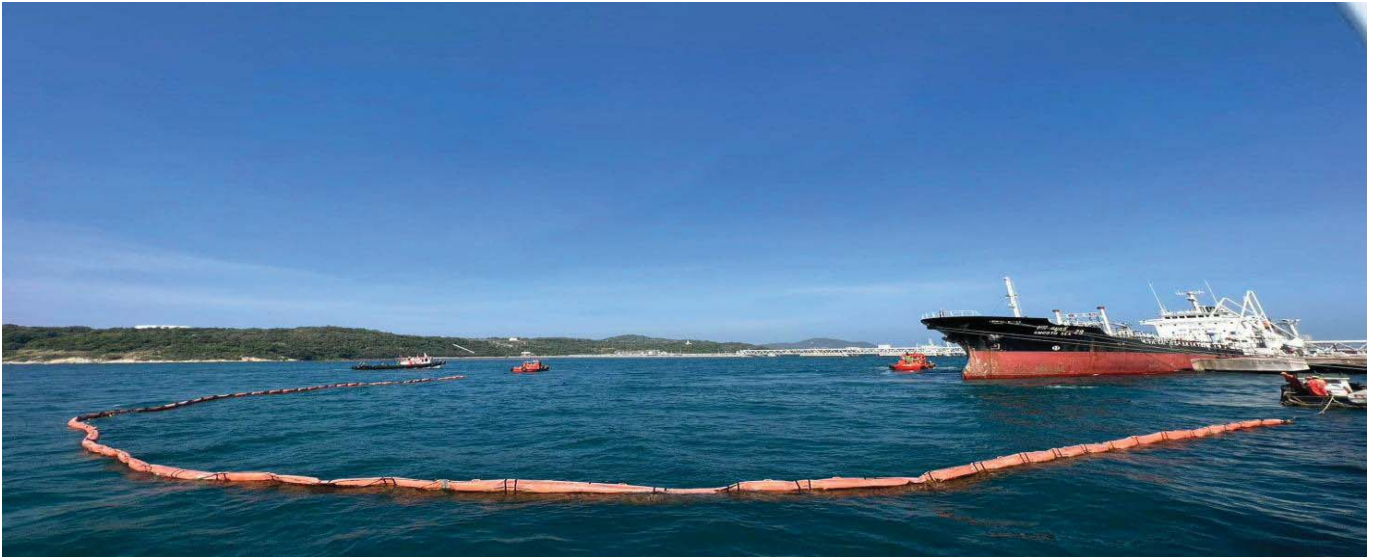
STT 9 เรือทัก และเรือรับเชือก ลาก BOOM ล้อมคราบน้ำมันตามคำสั่งผู้สั่งการ
