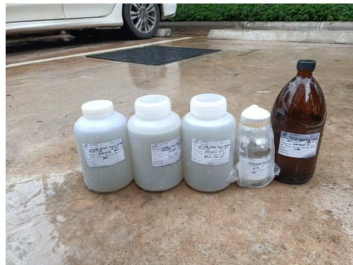
เก็บตัวอย่างคุณภาพน้ำทิ้ง จุด F บ่อพักน้ำสุดท้ายก่อนระบายลงท่อระบายน้ำสาธารณะ
