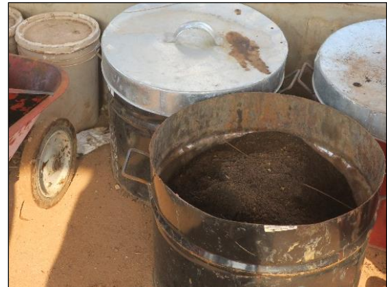
ภาพที่ 2.2-2 อุปกรณ์ดับเพลิงและขจัดครบน้ำมันประจำฐานหลุมผลิตหนองแสง-เอ (NSG-A)
