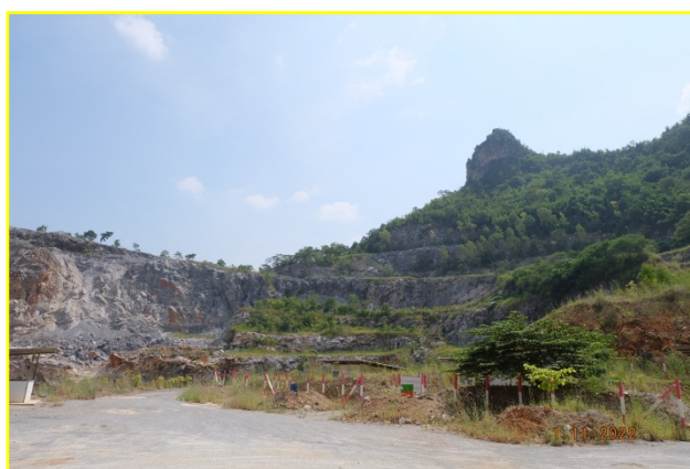
ภาพที่ 2-4 การทำเหมืองแบบขั้นบันได
