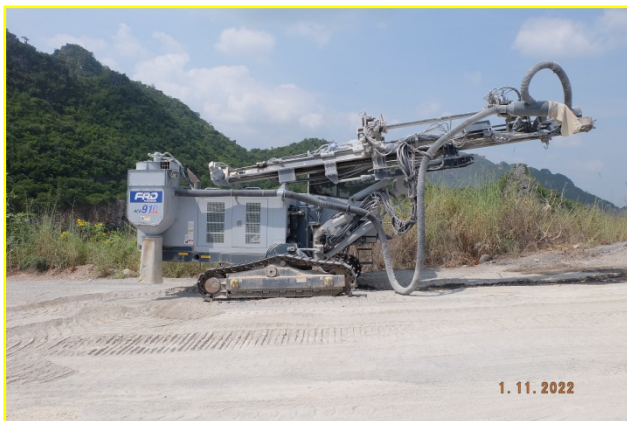
ภาพที่ 2-8 เครื่องเจาะระเบิดที่มีถึงดักฝุ่นบริเวณหัวเจาะ
