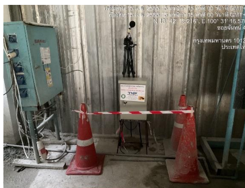
รูปที่ 19 ติดตั้งเครื่องตรวจวัดคุณภาพสิ่งแวดล้อม (คุณภาพอากาศ ระดับเสียง เสียงรบกวน และความสั่นสะเทือน)
