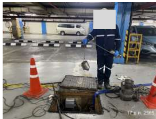
รูปที่ 2-24 แสดงการเก็บตัวอย่างน้ำทิ้งภายในอาคาร (3)
