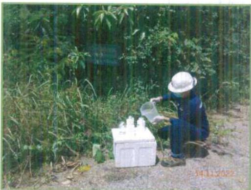
ภาพที่ 2-20 การเก็บตัวอย่างคุณภาพน้ำบ่อดักตะกอน
