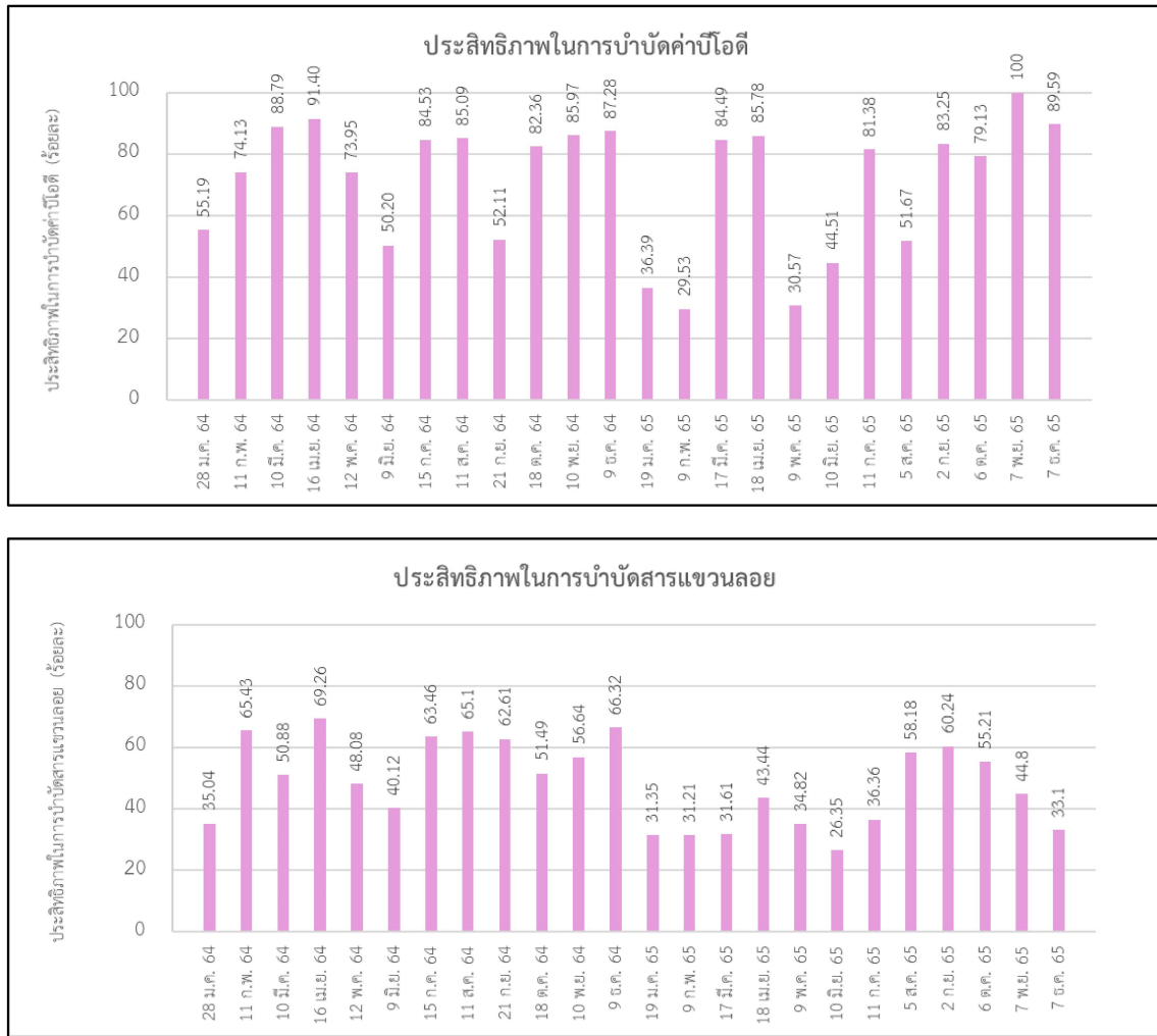
รูปที่ 3-7 เปรียบเทียบประสิทธิภาพของระบบบำบัดน้ำเสียของอาคาร B
