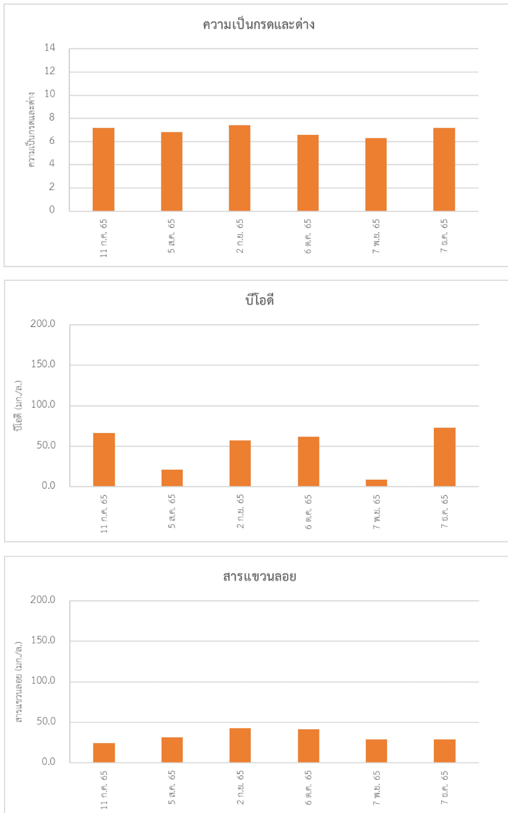
รูปที่ 3-3 คุณภาพน้ำทิ้งในถังปรับสภาพก่อนการบำบัด (ถังแยกตะกอน) ของระบบบำบัดน้ำเสียอาคาร B
