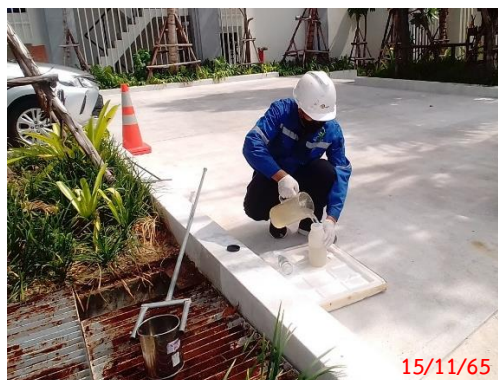
รูปที่ 3.2-1 วิธีการเก็บตัวอย่างน้ำทิ้ง ที่มา : บริษัท กรีน เอ็นไว เอ็นจิเนียริง จำกัด, 2565
