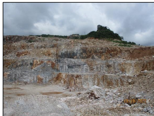
รูปที่ 2-7 สภาพการทำเหมืองแบบขั้นบันได
