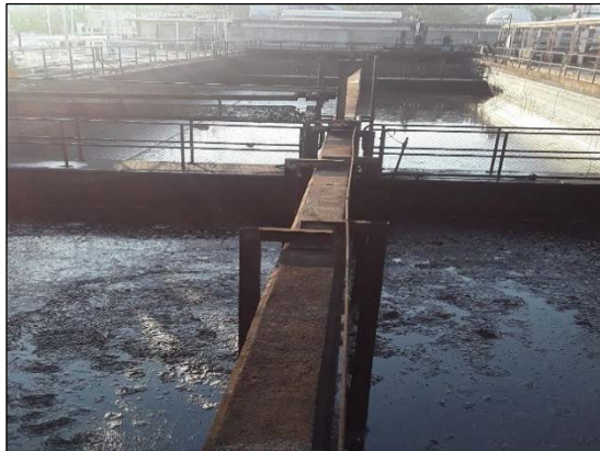
ภาพที่ 2.3-5 API Separator ที่สถานีผลิตลานกระบือ
