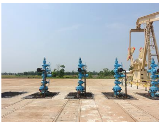
ชุดวาล์วหัวบ่อ (Christmas Tree) และบ่อเก็บน้ำบริเวณวาล์วหัวบ่อ (Well Celler Pit)
