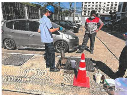
ภาพที่ 3.5.3-1 การเก็บตัวอย่างน้ำระบบบำบัดน้ำเสีย
