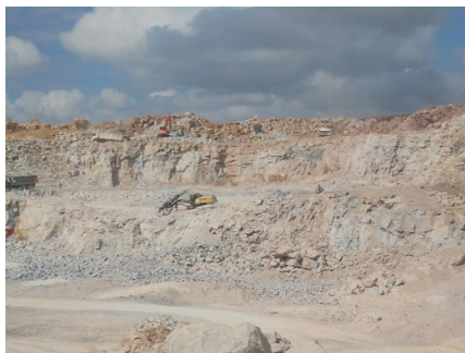
รูปที่ 2-38: การทำเหมืองแบบชั้นบันได
