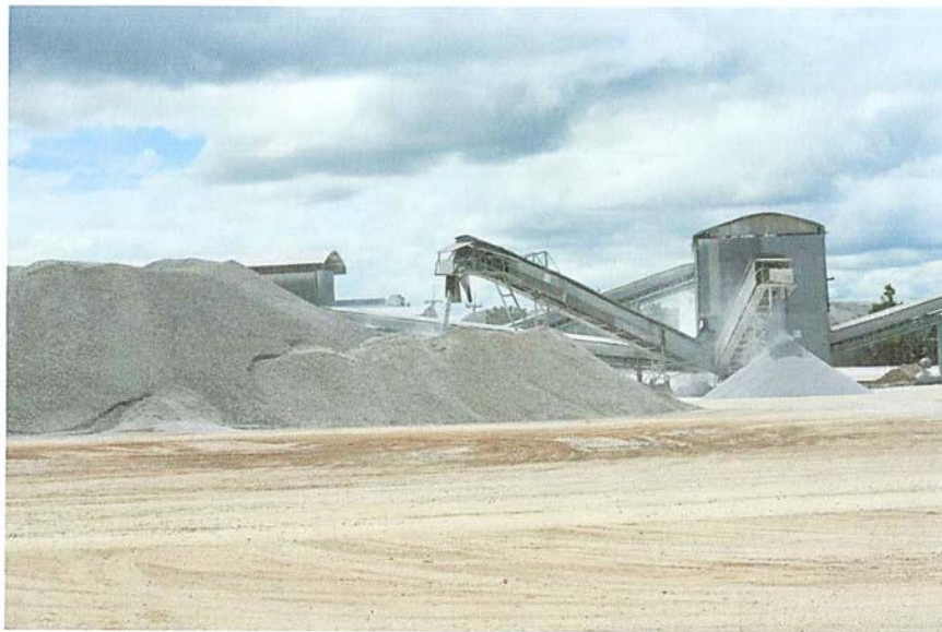
รูปที่ 15 อาคารปิดคลุมโรงโม่หินส่วน Secondary และ Tertiary crusher
