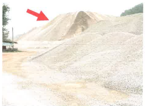
รูปที่ 5 เปลือกดินจากหน้าเหมื่อนนำมาผสม เป็นหินคลุก
