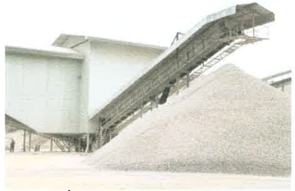
รูปที่ 16 การปิดคลุมสายพานลำเลียง
