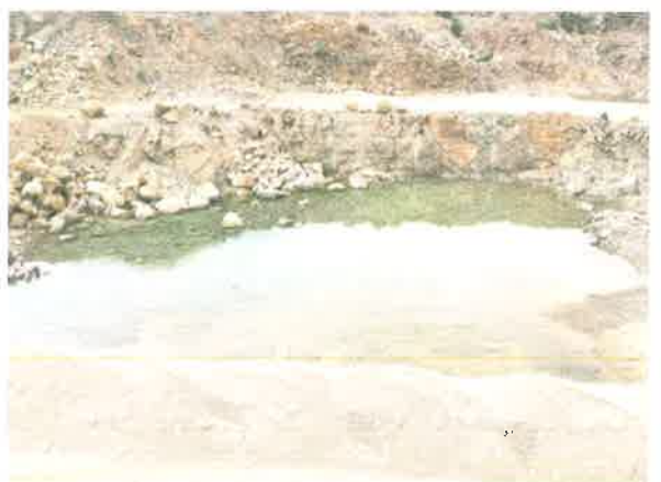
รูปที่ 6 พื้นที่รับน้ำขุ่นข้นและตะกอนดิน บริเวณหน้าเหมือง
