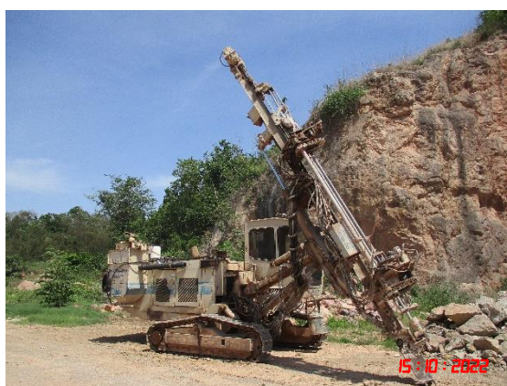
รูปที่ 19 เครื่องเจาะรูละเบิดที่มีอุปกรณ์เก็บฝุ่นติดไว้กับหัวเจาะ
