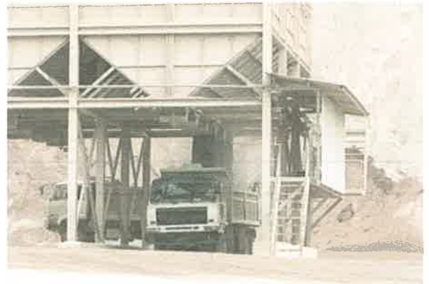
รูปที่ 17 การออกแบบยังเก็บหิน เพื่อลดการฟุ้งกระจายของฝุ่นหินจากปลายสายพาน
